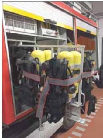
Mit dem Austausch der Atemschutztechnik war es nur noch lange nicht getan. Natürlich musste die neue Technik auch mit neuen Halterungen und Geräteauszügen auf unserem Tanklöschfahrzeug und unserem Hilfeleistungslöschfahrzeug verlastet werden. Diese wurden entsprechend durch den Feuerwehrfahrzeugbauer Ziegler Feuerwehrgerätetechnik in Mühlau eingebaut.
