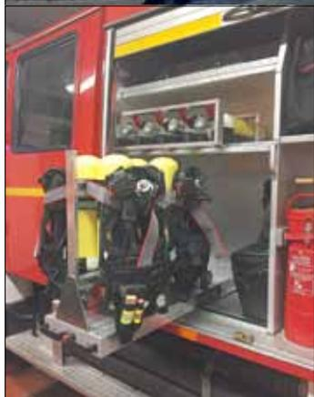
**Neue Atemschutztechnik für die Feuerwehr Schlettau**
